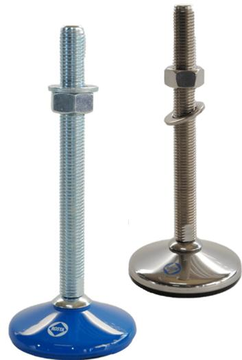
Pies de montaje compuestos por placa aislante y tapa superior con tornillo de nivelación incorporado con junta esférica para compensar hasta 10 ° de desnivel en el suelo. Placa aislante resistente al aceite y al ácido. Frecuencia natural entre 19 y 27 Hz.
