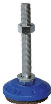
Pies de montaje formados por una almohadilla metálica aislante. Aísla el ruido transmitido por las estructuras. Almohadilla de acero cromado resistente a temperaturas de –40 °C a +250 °C. Resistente a la corrosión, las grasas y los disolventes. Frecuencia natural entre 14 y 26 Hz. Se permite una carga de choque dinámica de hasta 3 g. Vida útil ilimitada.
